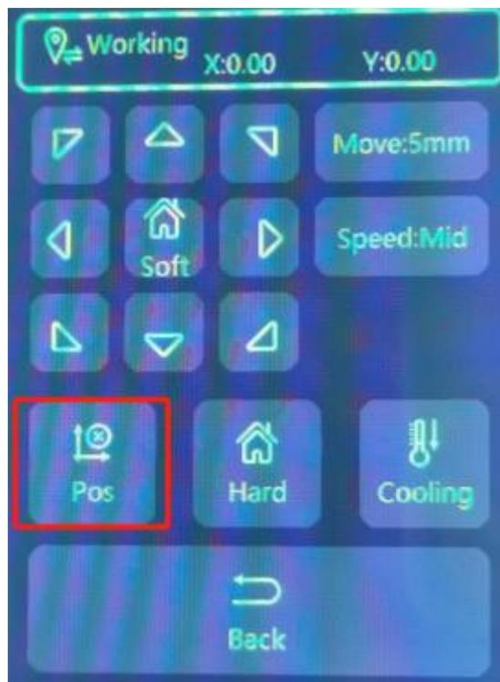
Pos : Pos ボタンをクリックすると、現在のレーザーヘッドの位置が作業原点（Working）として設定され、上記の作業原点座標が 0 にリセットされます。
