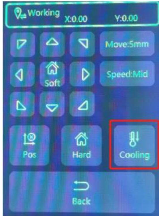
Cooling : 放熱ボタンは、デバイスを開いた後、デバイスの外部冷却システムをアクティブにします(A1 などの一部のデバイスモデルには外部冷却システムがないため、この機能は無効です)。
