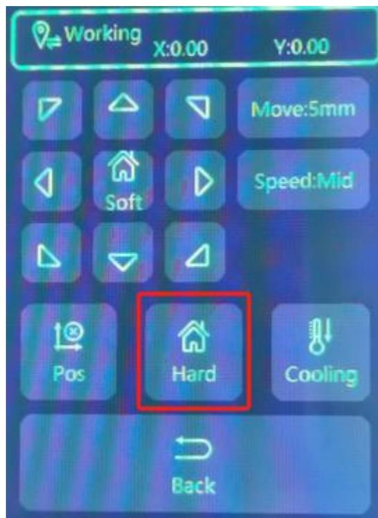
Hard :ハードウェアリセットボタンは、ボタンをクリックした後、レーザーヘッドは機械的な原点（Mechanical）に移動し、機械的な原点は(X0、Y0)であり、作業原点（Working）も同時に 0 にリセットされます、つまり、ユーザーが手動で設定した元の位置はリセット後に失われるため、特別な注意が必要です。
