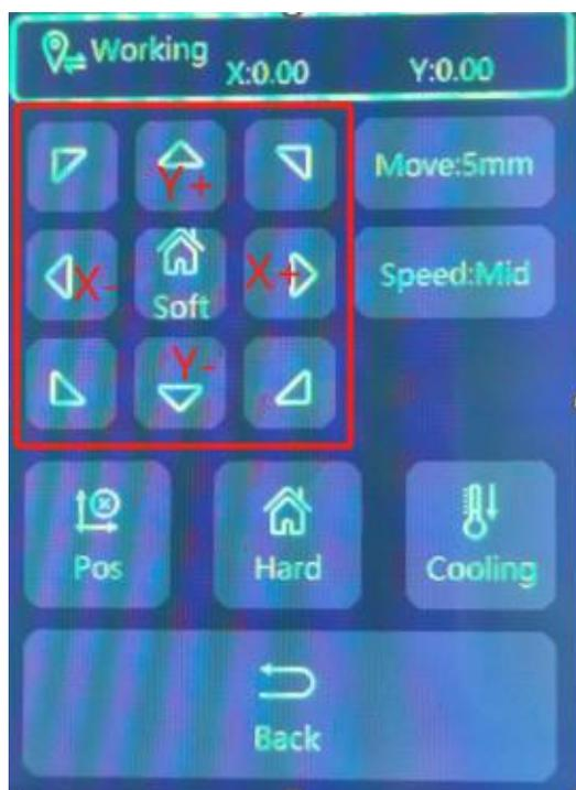
矢印キーとソフトウェアリセットボタンを移動:その移動方向は示されている図に対応し、中央のソフトはソフトウェアリセットボタンであり、ユーザーが手動で原点を設定した後、ボタンをクリックしてユーザーが設定した原点に戻ることができます。
